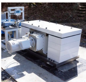
図1. 小型連続震源装置の写真。約1mの大きさ。連続的に発振した振動を足し合わせることで、シグナルを強調できる。
