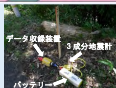
独立型地震観測装置の設置風景
