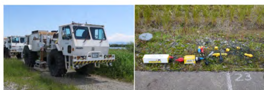
大型バイブレータ震源の稠密発振
