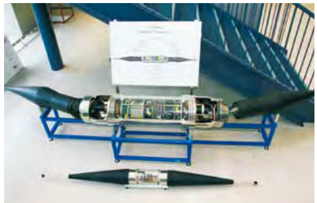
従来のケーブル式海底地震計観測ノード(上) 新規開発された観測ノード(下)
