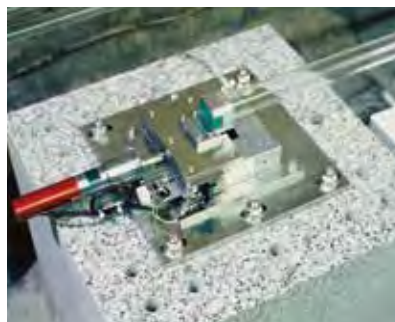
伸縮計の固定端と感度検定用アクチュエーター
