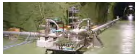
神岡鉱山に設置されているレーザー歪計
