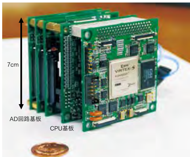
新規開発された観測ノードに搭載している小型の電子回路ユニット
