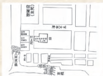
1854年伊賀上野地震の際の伏見での局所的な液状化
