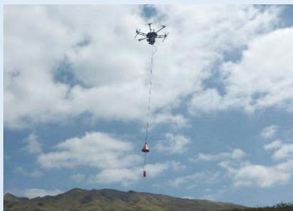
我々はドローンを「観測ロボット」として活用することで、火山上空のあらゆる場所で電磁場を計測し、火山体構造の解明を行っています。
