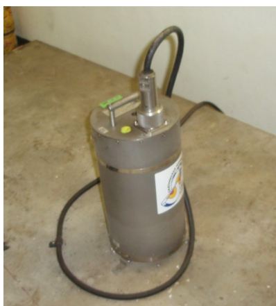
観測で使用している広帯域地震計
