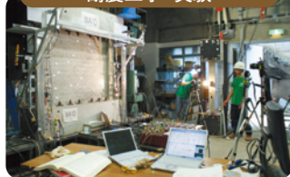
構造部材の耐震実験
